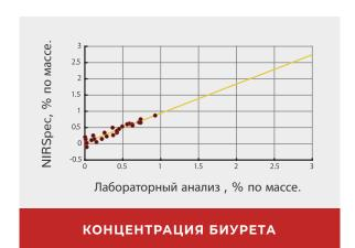
Мы разработали уникальное решение ПАТ (Процессной Аналитической Технологии) для поточного анализа состава КАС, которое позволяет измерять не только концентрации трех основных компонентов КАС, а именно: Мочевину, Нитрат Аммония и Воду, но также концентрацию нежелательного побочного продукта- Биурета, которая становится все более важным параметром качества продукта КАС.
